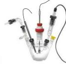
H<sub>2</sub>SO<sub>4</sub> 0,5 M, naturalmente aireado y en reposo. ET: disco de acero encapsulado en Teflón. CE: Pt. ER: ESC
